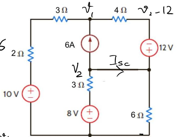
$$\frac{v_1 - 10}{5} + \frac{v_1 - (v_2 - 12)}{4} = 6$$
