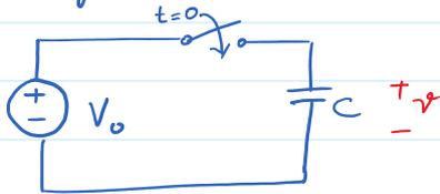
$$v = \begin{cases} V_0 & t \geq 0 \\ 0 & t < 0 \end{cases} = V_0 u(t)$$
